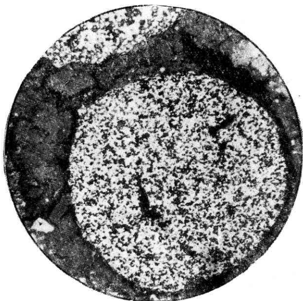
Рис. 2. Випалені ооліти, складені магнетитом (світло-сіре) та силікатом (темно-сіре); сіре — скріплююча речовина. Відбивне світло. \times 70 .
