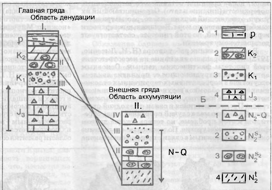
Рис. 2. Принципиальная схема коррелятивных взаимоотношений между областью денудации – Горный Крым, яйла – и областью аккумуляции – Предгорье, Внешняя гряда.
