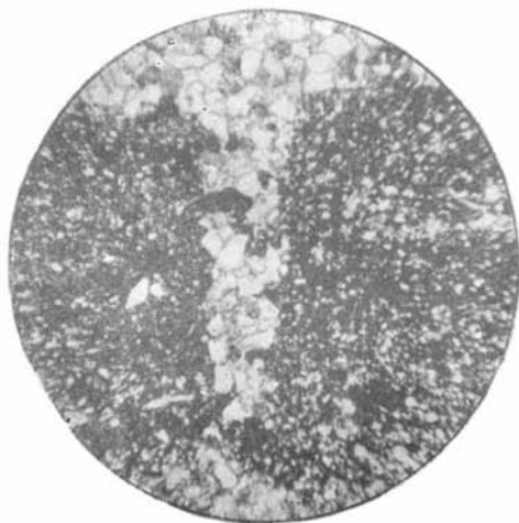
Рис. 10. Трещина усыхания в красноцветной глинистой корочке, покрывающей глинистый алевролит.
